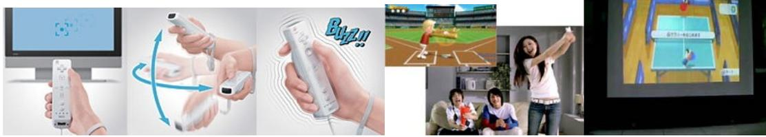
Wii 是一種利用虛擬實境技術的電腦遊戲機，它的主要特色在於無線的控制器，稱作「Wii Remote」或「Wii-mote」。控制器可以作為指向裝置，並可進行三度空間中的動作和旋轉偵測，而電腦螢幕畫面會隨著控制器的位置而產生改變。控制器中同時包含揚聲器（喇叭）和震動裝置以提供感應的回饋。控制器同時也可以連至網際網路接受訊息或更新檔案。「感應棒」（Sensor bar）是用來偵測三度空間的裝置，連接埠位在機器的背面。
