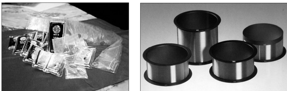
圖 13-6 純金製品，銀樓展售之純金塊 ( 左 ) 及光電半導體工業所用的純金電子連接線 ( 右 )
